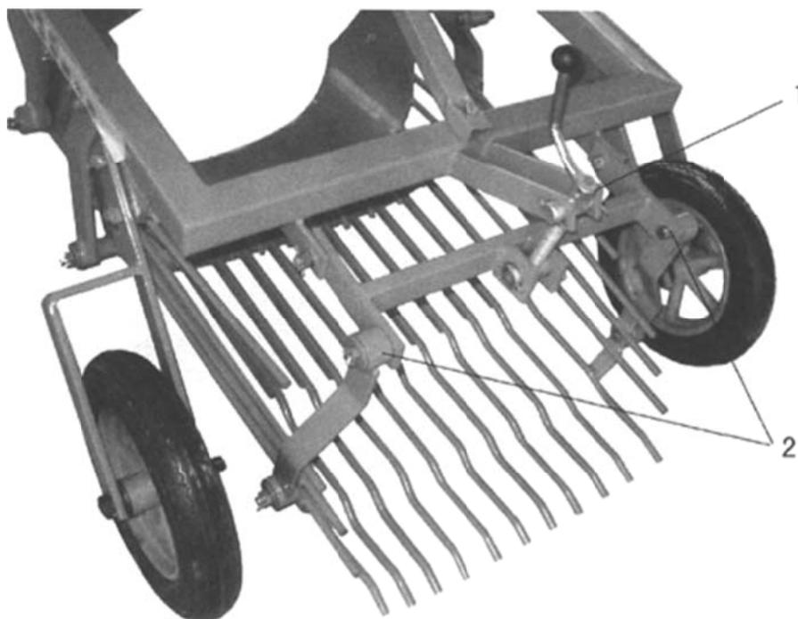
Для установки положения регулировочной опоры ослабьте затяжку болта (2) и поверните ручку (1) в требуемое положение.
