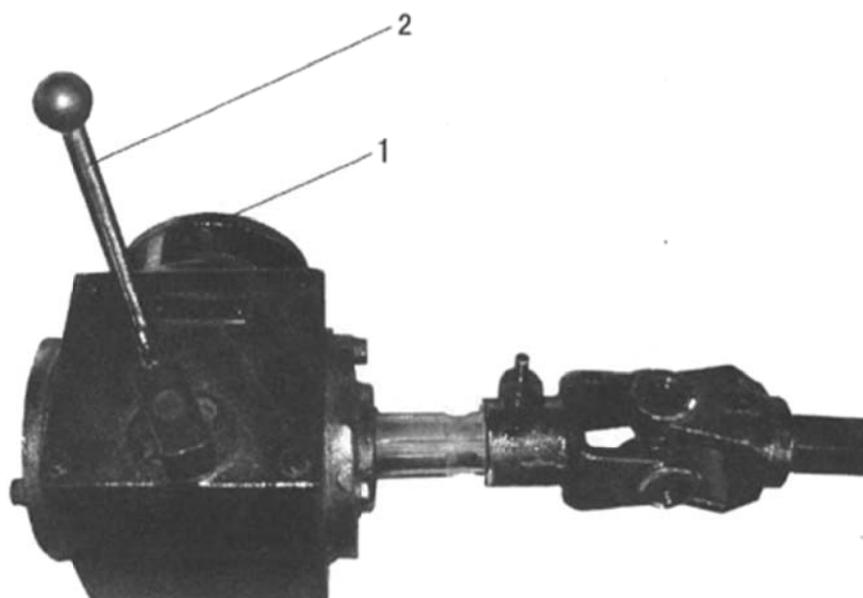
Подсоедините один конец карданного шарнира (3) к шлицевому валу картофелекопателя, а другой конец (4) – к редуктору. Закрепите.
