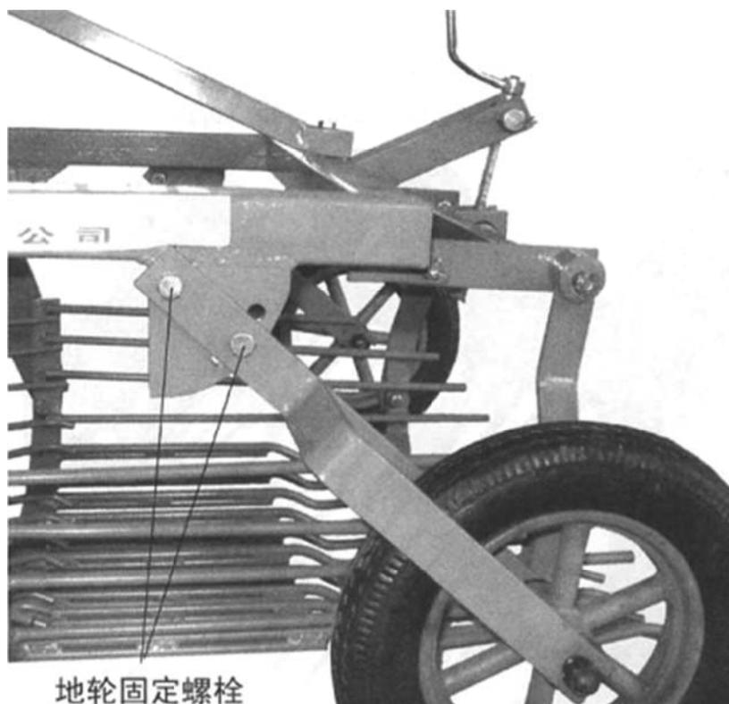
Ослабьте затяжку болтов колеса, установите требуемую высоту и затяните болты.
