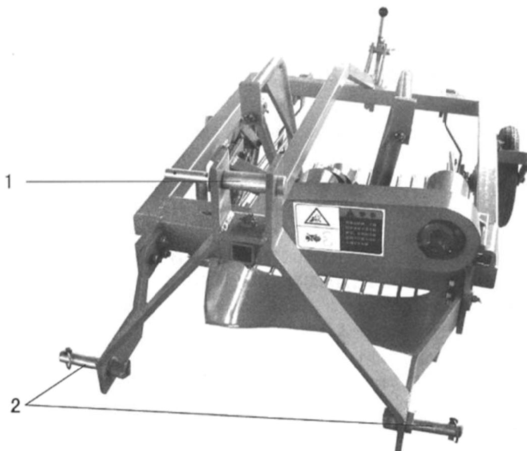
Машина подсоединяется к ВОМ трактора посредством редуктора и карданной передачи.
