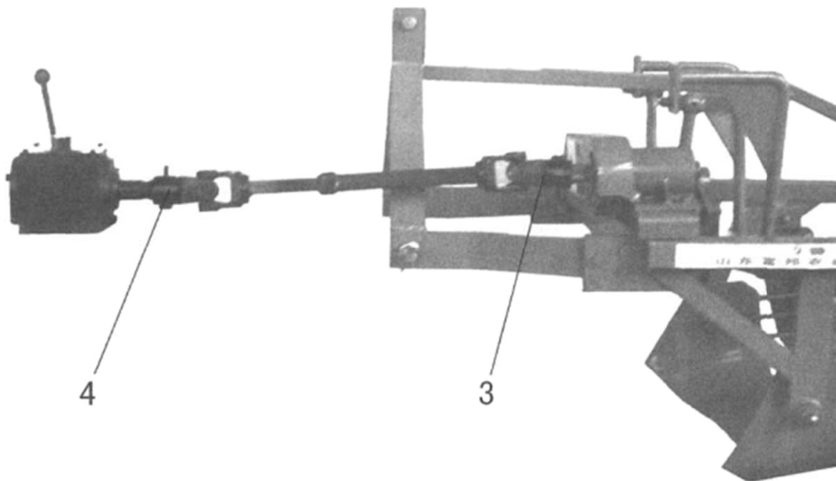
После подсоединения убедитесь, что угол наклона карданного сочленения по горизонтали составляет не более  $35^\circ$  (во время эксплуатации).
